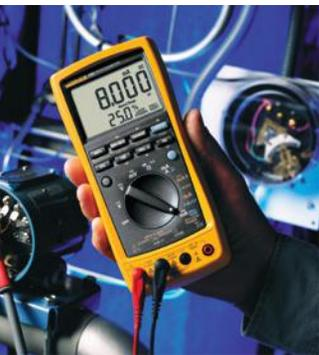
Fluke 789 ProcessMeter는 CAT IV 600V 등급의 DMM과 mA 루프 캘리브레이터 두개의 장비를 하나로 결합하였습니다. 측정 기술자를 위한 완벽한 장비입니다.
